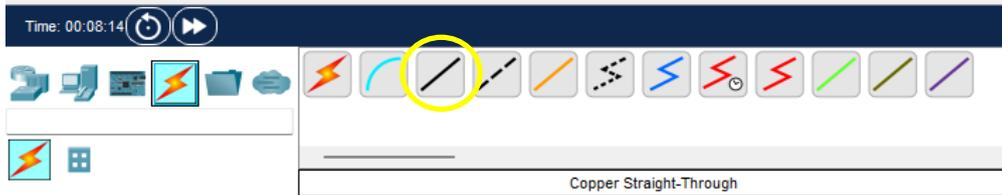
4. Poner enlace especial entre los dos switches para hacer el posterior trunk y que pasen los vlan's. Seleccionaremos los puertos a través de los que se hace la conexión física.
